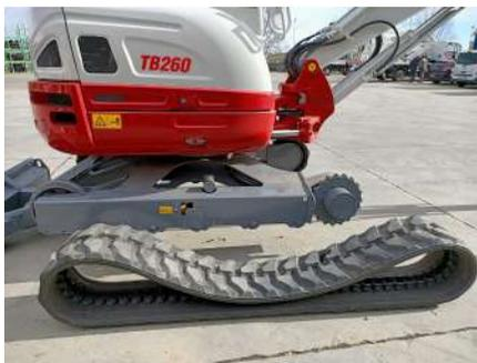
verificare il senso di rotazione del battistrada (se direzionale) e rispettare il senso di marcia verso la lama.
